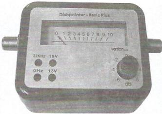
1. Verbinden Sie das Koaxialkabel vom LNB mit dem Anschluss „TO LNB“ (links) des Satfinders.
